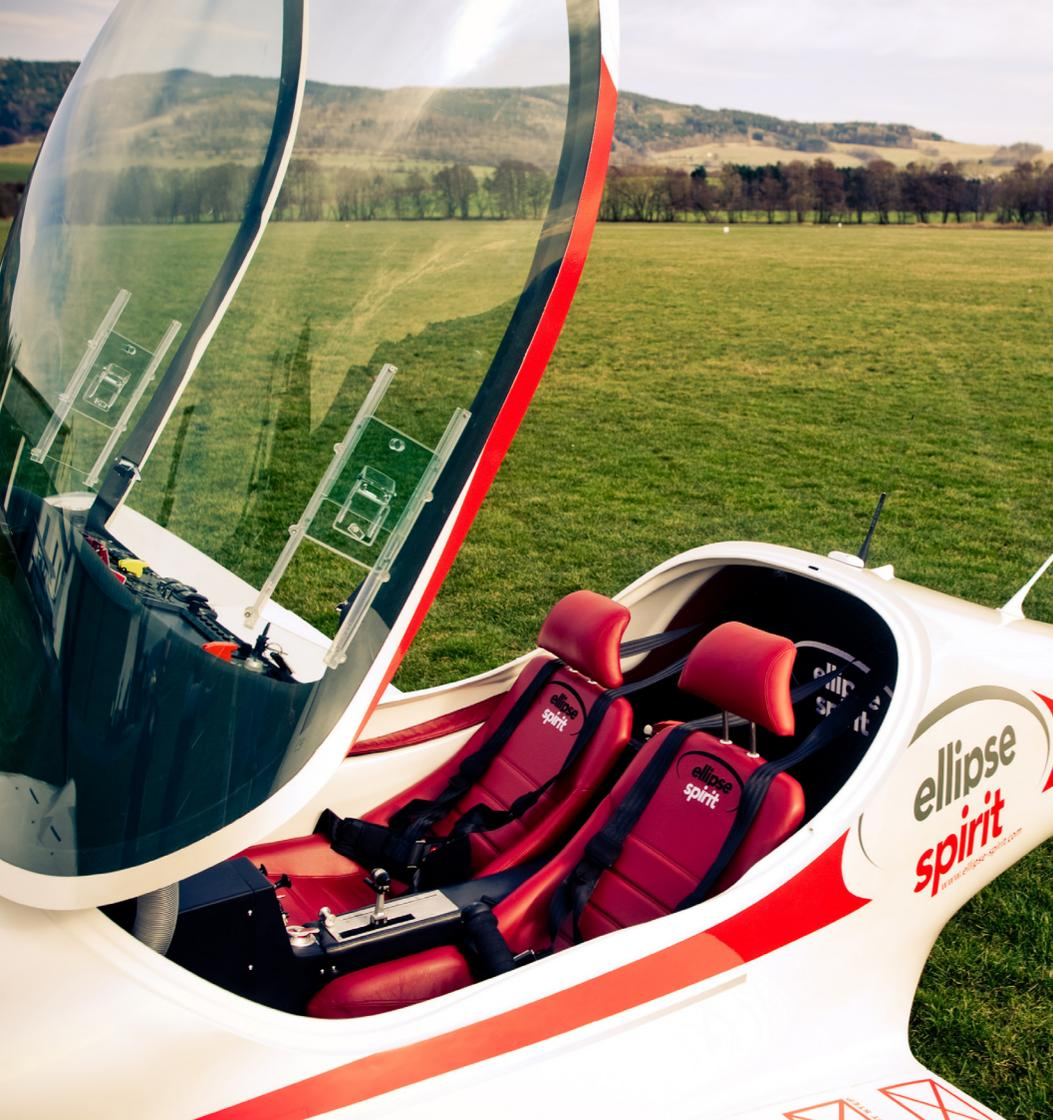
Le fuselage monocoque construit en fibre de carbone composite offre une cabine de pilotage de 120 cm de large. L'équipage est assis confortablement, et en sécurité grâce à la conception de la forme de la coque. Comme on peut ajuster les sièges très facilement, le cockpit peut devenir encore plus spacieux, et convient même aux grands pilotes. Vous serez surpris déjà en montant à bord car le panneau d'instruments est intégré dans la verrière, et les 2 s'ouvrent en même temps.
