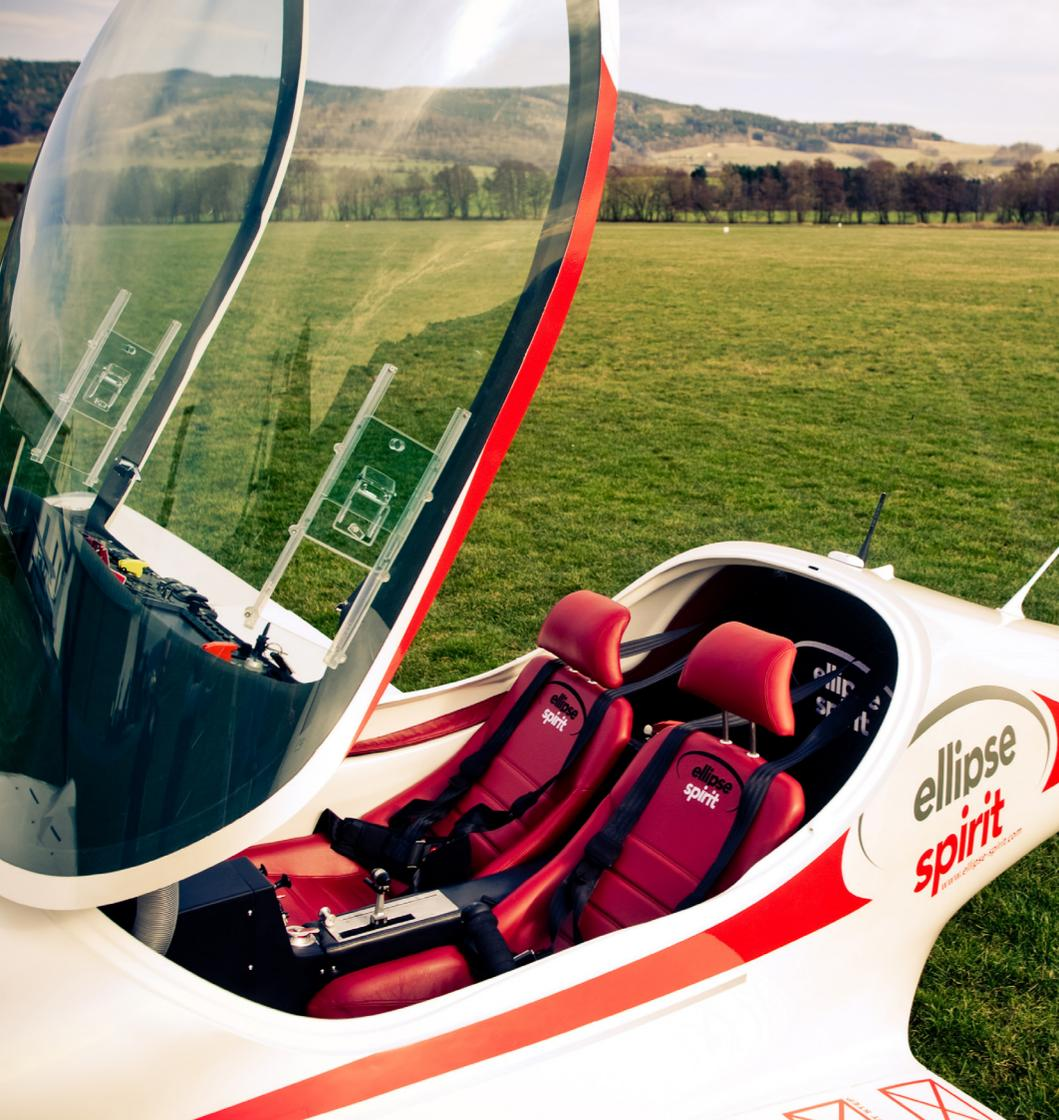
碳纤维合成材料制造的硬壳式机身提供了相当好的延展性，120 厘米宽的双排座舱，蜂窝夹心的外壳设计使得驾驶员座舱安全舒适。座椅和方向舵踏板整体可调节。最大的亮点是登机的时候你会发现整个仪表盘是机舱盖的集成部分。侧杆的使用使得进入座舱的程简单轻松。可调节的座椅和踏板，即使是身材高大的飞行员也可获得充足的腿部空间。两种可供选择的机舱华盖模型。独特的侧杆设计控制副翼和升降机的精确性。驾驶员的手臂被扶手支撑，允许在飞行过程中进行灵敏细微的控制杆操作。UL飞机固定起落架机型最大巡航速度 250km/h,收放起落架机型最大巡航速度 280km/h.
